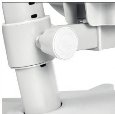
Для регулировки высоты сиденья поверните фиксатор против часовой стрелки и оттяните его. Затем поднимите или опустите сиденье кресла на нужную высоту, затем отпустите фиксатор и поверните его по часовой стрелке.
