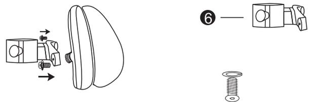
Оденьте спинку кресла сверху на каркас. Сначала снимите ручку, чтобы пружинный штифт не заблокировался, и затяните ее до положения отверстия, как показано на рисунке.
