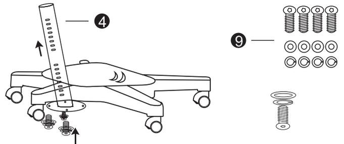
Оденьте сиденье сверху на каркас. Сначала снимите ручку, чтобы пружинный штифт не заблокировался и затяните ее до положения отверстия, как показано на рисунке.
